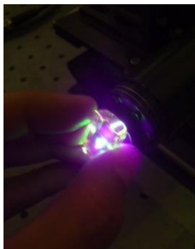
Figura 3.20: Barra de \text{TeO}_2\text{-Er}^{3+}/\text{Yb}^{3+} emitiendo en IR
