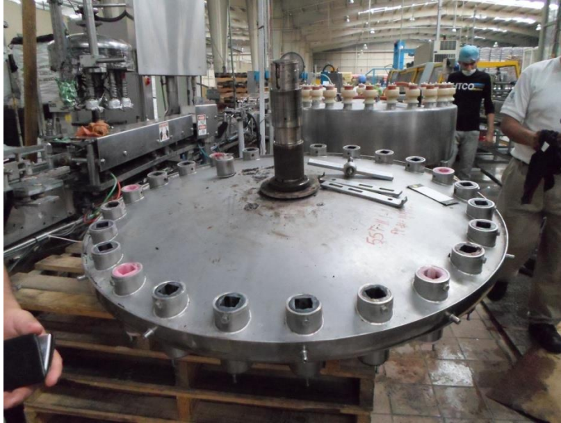
Fig. 5 Cambio de diafragmas de la llenadora Fogg 24/8.
