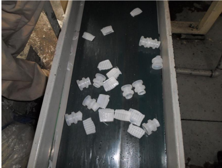
Fig. 4.1 Corte del cuello y colillas de las botellas.
