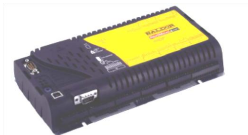
Ilustración 16 . Controlador inteligente NextMove e 100
