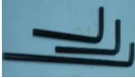
**Figura 3.9** llave Allen para ajuste de piña
