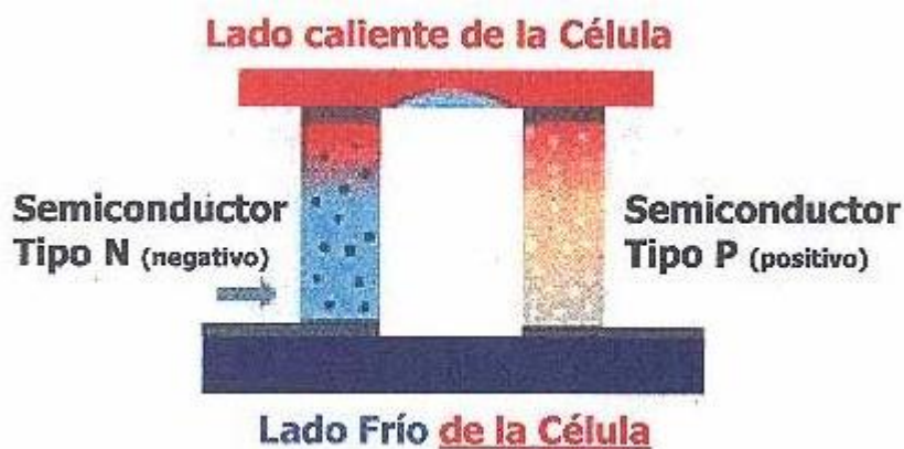
fig.7.- esquema de funcionamiento de una célula peltier:
