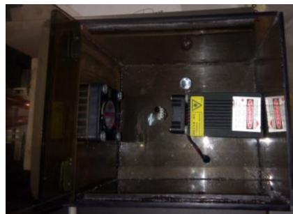
Montado del dispositivo laser en el espacio frio.
