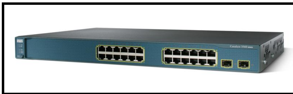
Figura 4.1 Switch Cisco catalyst 3560 serie
