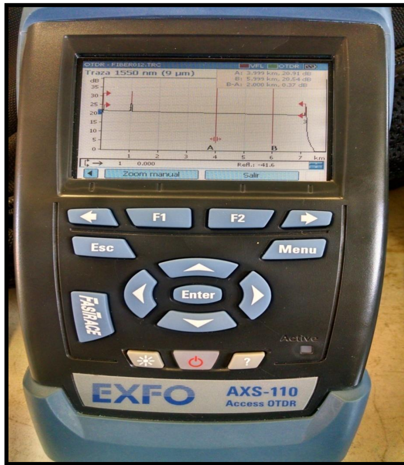
Figura 7.3 Medición para verificar la pérdida
