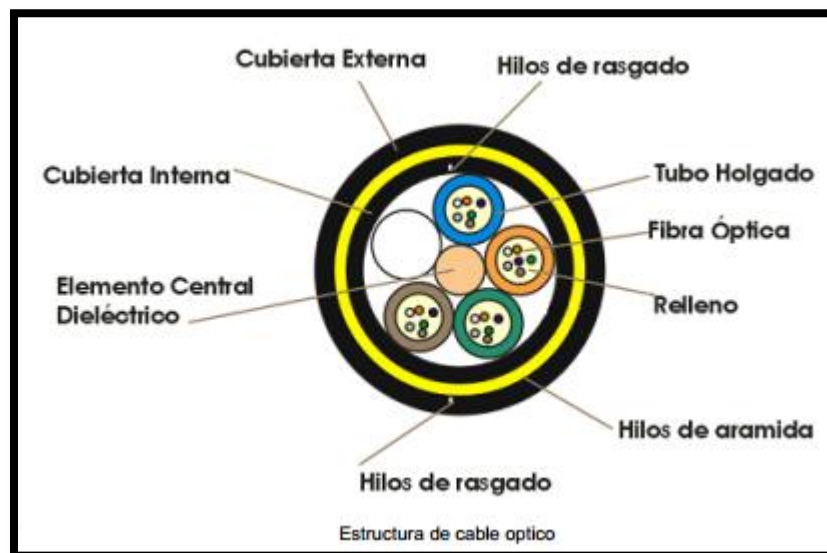
Figura 4.5 Estructura del cable óptico ADSS de 36 hilos
