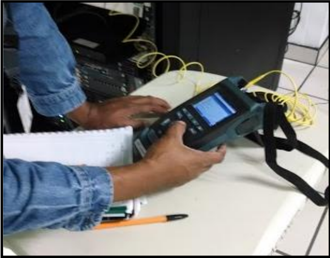
Figura 6.4 Realización de pruebas con el OTDR
