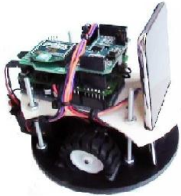
Fig. 1.1 Robot Móvil con Arduino y un iPod para la transmisión de video inalámbrico por WiFi[2].
