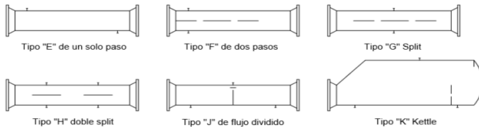
Figura 8. Diferentes tipos de corazas establecidos en la norma TEMA. Fuente: (TEMA, 2007)
