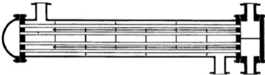
Figura 20. Intercambiador de calor de lámina tubular flotante. Fuente: (KERN, 1999).
