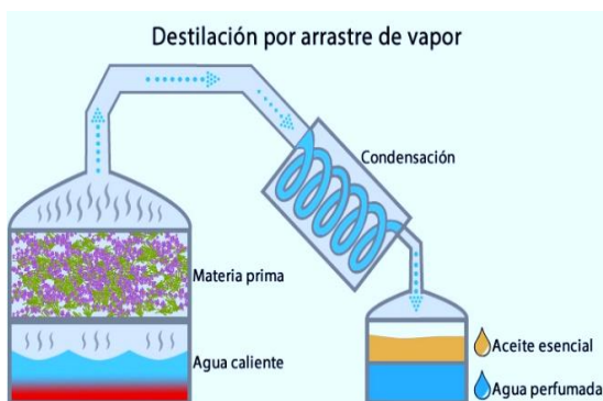
Ilustración 4. Destilación por arrastre de vapor.
