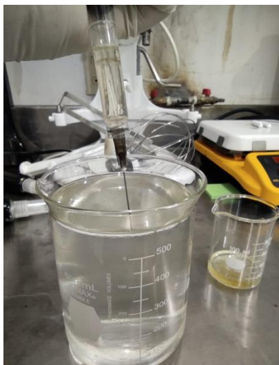
Ilustración 13. extracción del aceite esencial del agua hidrolada mediante el uso de una jeringa
