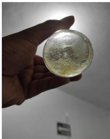
Ilustración 14. Presencia de óxido de cobre en el aceite esencial obtenido.
