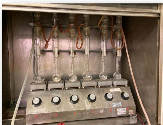
Figura 15.- Análisis para la determinación de fósforo total
