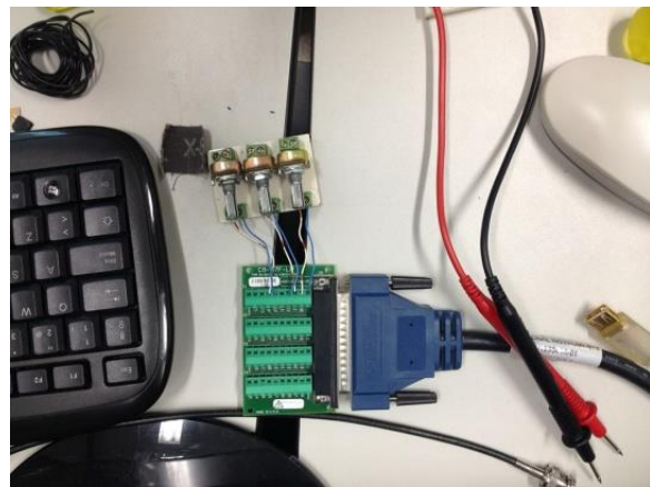
Figura III.1 El block terminal leería las 3 señales.
