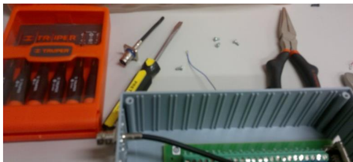
Figura III.3 Cambio de terminal BNC debido a ruptura.
