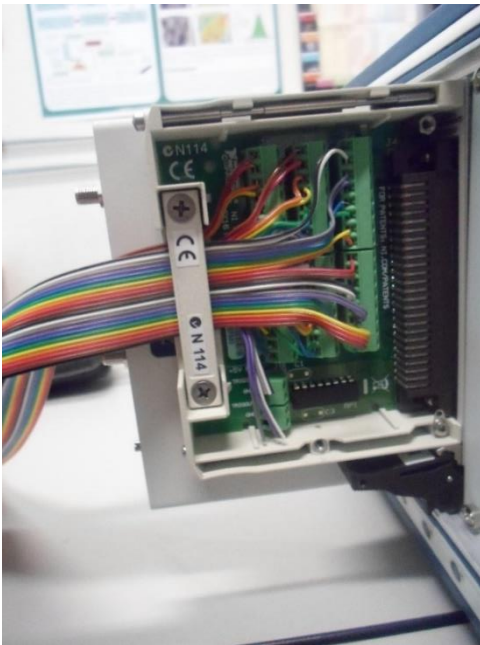
Figura III.27 Cable plano de colores para identificar cada terminal.
