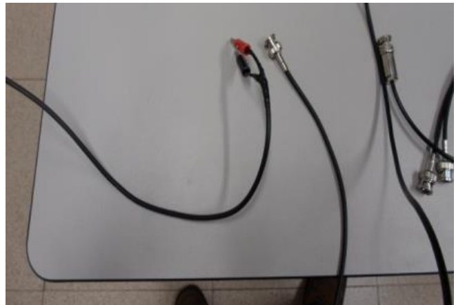
Figura III.10 Cable adaptado de BNC a bananas
