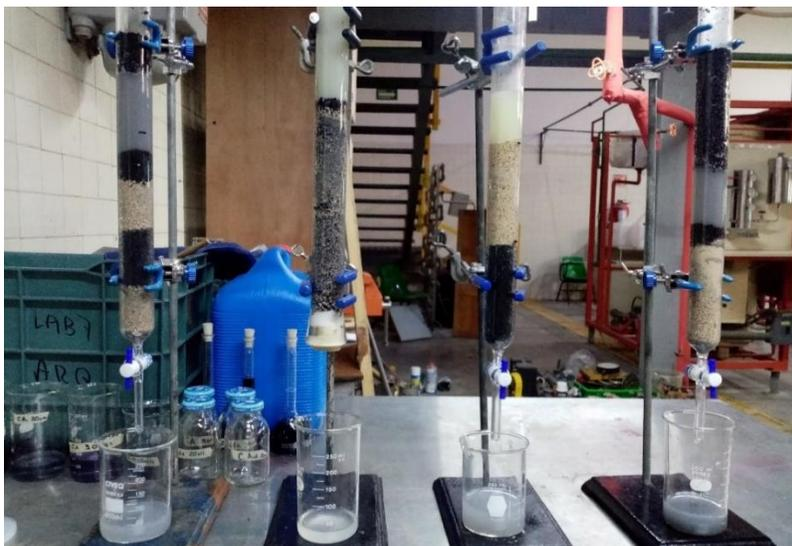
Figura 18. Segunda corrida de las columnas con diferentes combinaciones con diferentes tipos de adsorbentes con el suero de leche.
