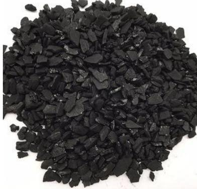
Figura 2. Carbón activado granular
