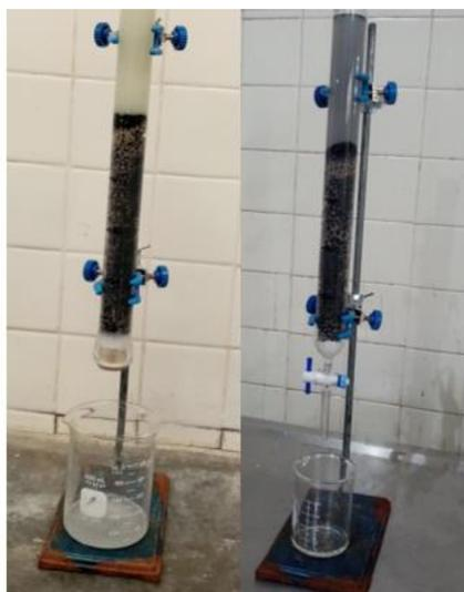
Figura 19. Columnas de adsorción empacadas con la mezcla de zeolita y carbón activado de lado izquierdo la primera corrida y del lado derecho la segunda corrida
