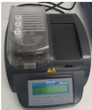
Fig. (13). Bloque de Reactor Digital marca Hach DRB 200.
