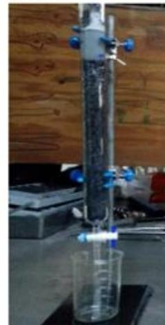
Fig (16). Columna empacada con carbón activado con una altura de 30 cm, con el suero de leche
