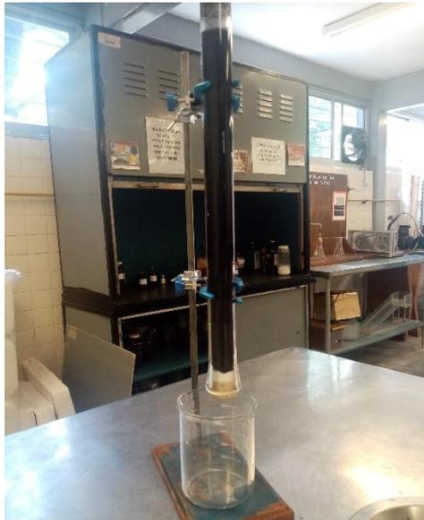
Figura 11. Columna de Adsorción empacada con carbón activado con una altura de 30 cm con un volumen de 150 ml de refresco del grupo FEMSA.
