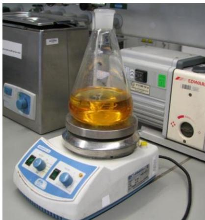
Figura 12. Agitador magnético con ácido acético en un matraz Erlenmeyer.
