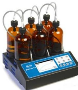
Fig. (14). BOD TRAK II Aparato de DBO respirométrico con accesorios.
