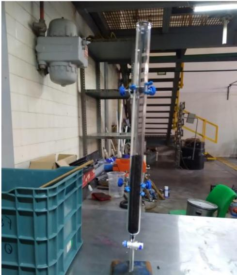
Fig. (10) Columna empacada con carbón activado granular con una altura de 20 cm
