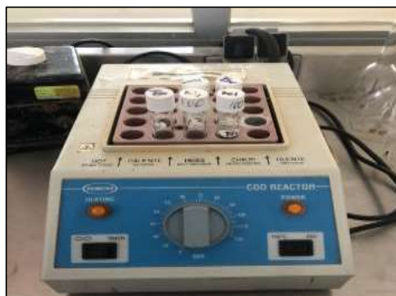
Imagen 7. Tubos de digestión con solución de calibración en el termo reactor.
