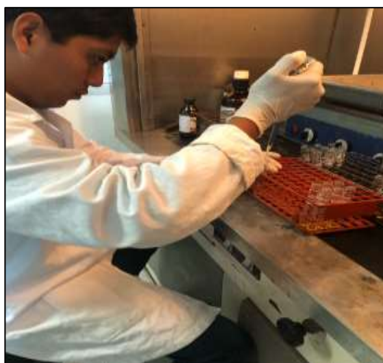
Imagen 6. Preparación de tubos de digestión para DQO- Tubos Sellados Concentración 150 mg/L
