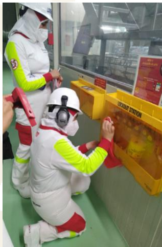
Ilustración 31. Limpieza estaciones LOTO
