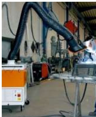
Figura 13.9. Boca móvil de aspiración de humos de soldadura.
