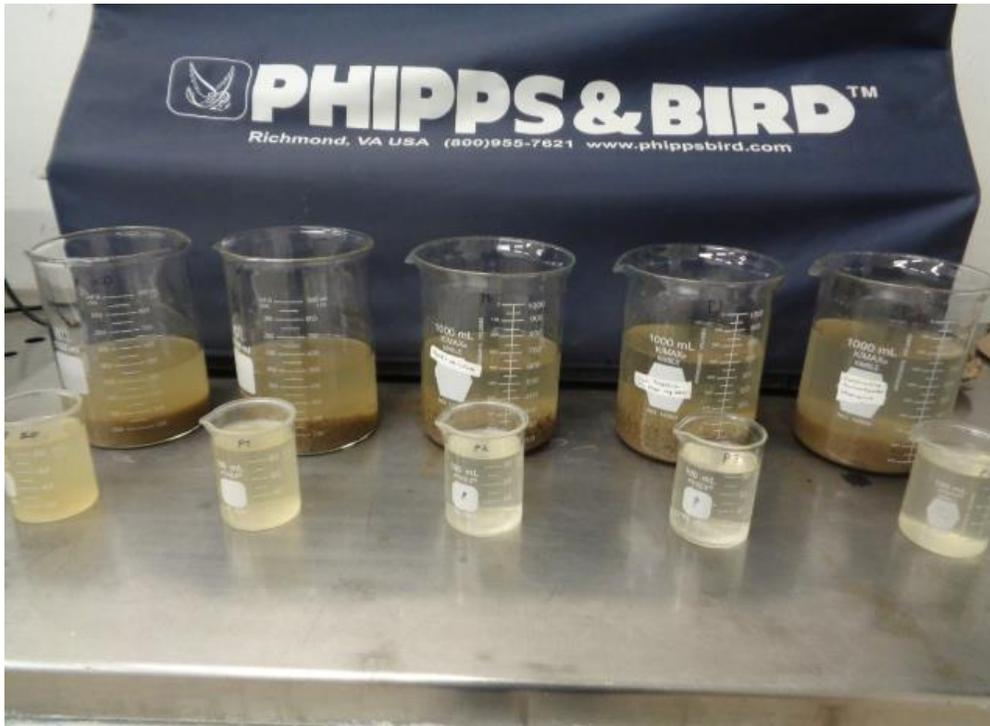
*Ilustración 7. Prueba de jarras con Starccoag.*
