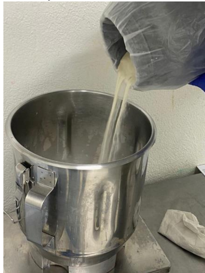
Figura 17. Goma xantan y óxido de zinc en una licuadora industrial
