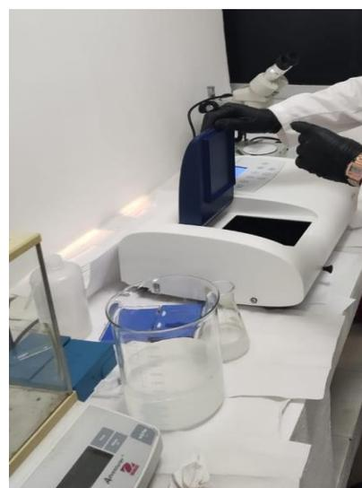
Ilustración 9 Espectrofotómetro
