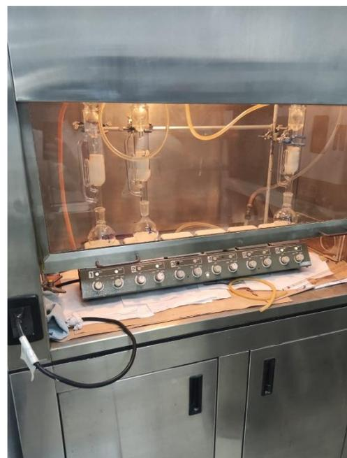
Imagen 13 Campana de extracción y equipo soxhlet
