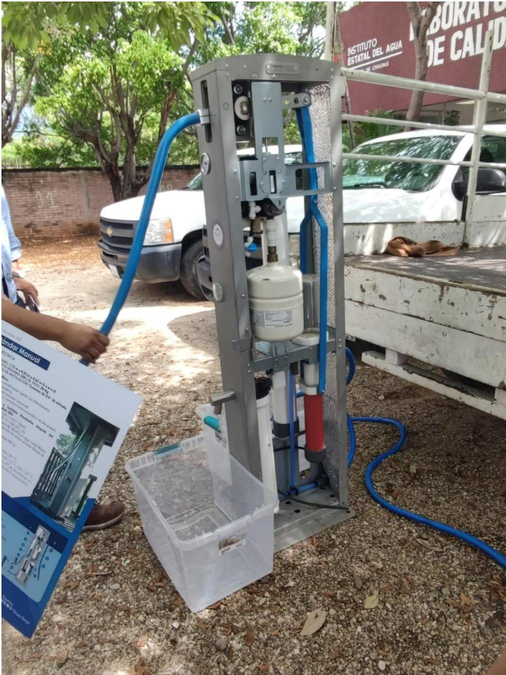
*Ilustración 2 Presentación del funcionamiento de un filtro purificador de agua para consumo*
