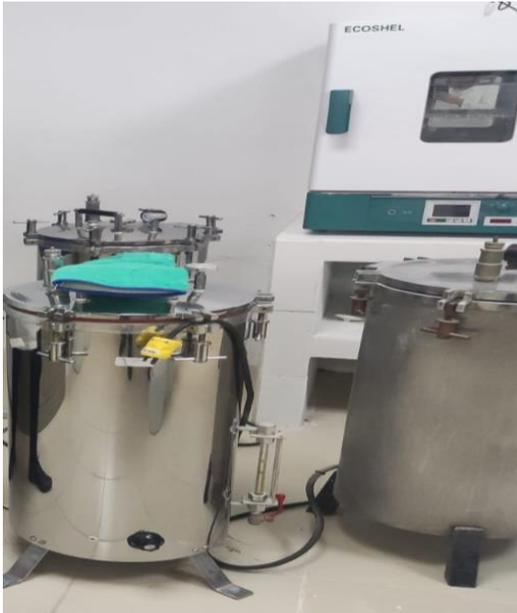
Imagen 12 Autoclave y Horno de secado
