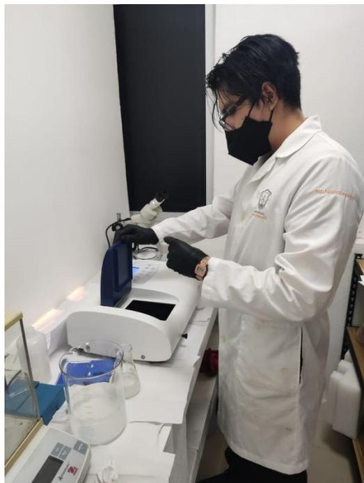
*Imagen 29 Análisis de la muestra en el espectrofotómetro, técnica de sulfatos*
