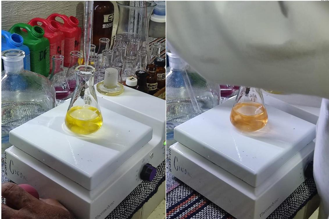
Figura 30. Fotografías de la valoración de la muestra de agua para determinar su valor de alcalinidad.
