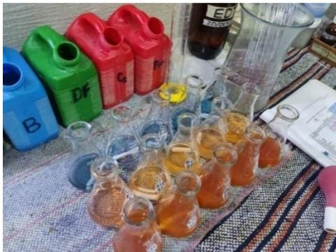
Figura 24. Soluciones resultantes del análisis de pruebas de contaminantes presentes en el agua.
