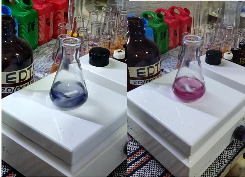
Figura 28. Titulación con EDTA de la muestra de agua con dureza
