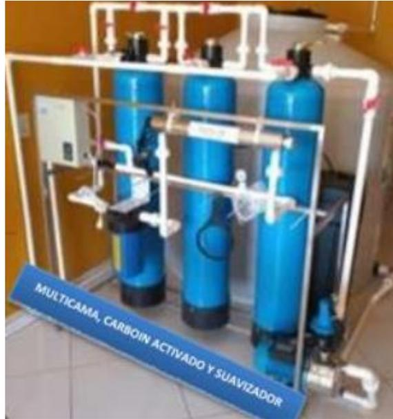
*Figura 77: Demostración de funcionamiento de una planta purificadora portátil.*
