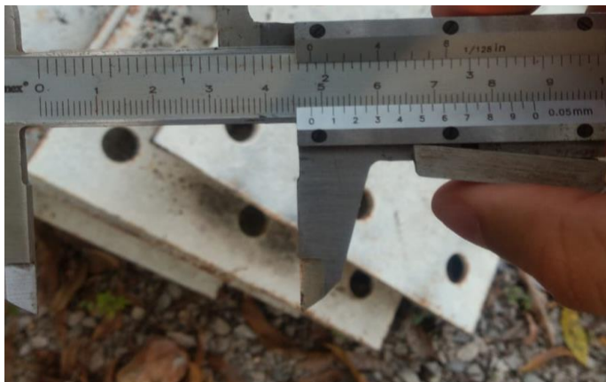
Ilustración 17 Medición del diámetro del lugar de colocación de boquillas en las placas
