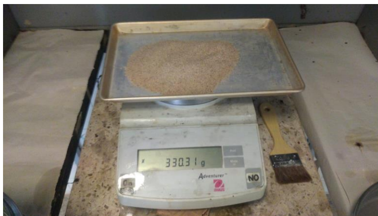
Ilustración 20 Pesaje de la arena sílica para obtener la composición en función del No. de malla
