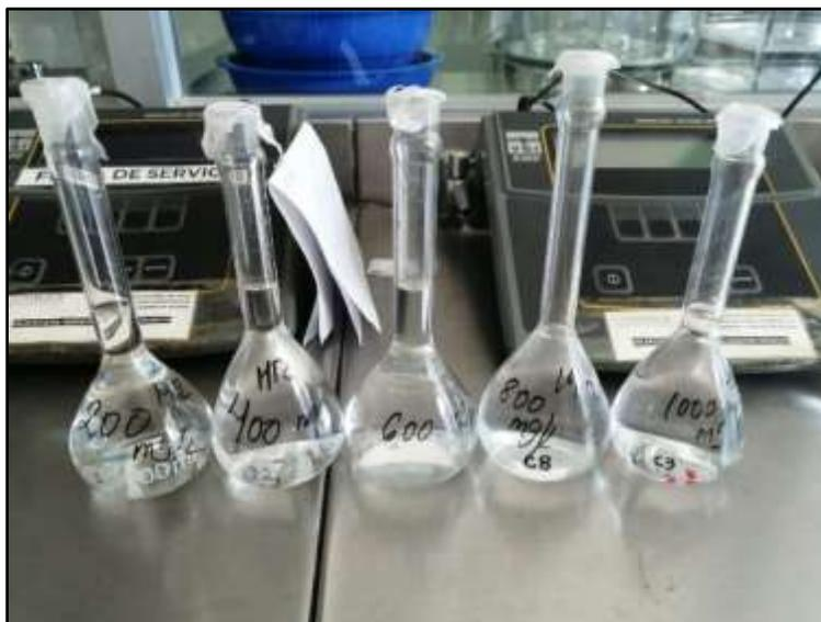
Al tener las disoluciones **altas concentraciones** se procede a sacar los tubos de digestión comercial para concentraciones altas y se colocan en una gradilla, para poder etiquetarlos con un plumón. Se etiquetan 2 tubos como blancos y un tubo para la concentración de 200 mg/L, 400 mg/L, 600 mg/L, 800 mg/L y 1000 mg/L. Dicho procedimiento de la preparación de las muestras de encuentra en el anexo 15 (pag. 160).
