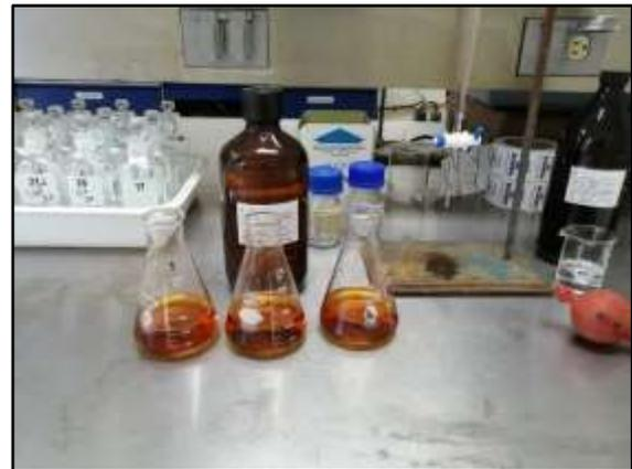
Al tener el valor de la molaridad del tiosulfato de sodio conocido, se procede a preparar las muestras como se indica en el anexo 8 (pag. 153), ósea, las botellas winkler con la disolución de sulfato manganoso, la disolución de alcalina yoduro-azida de sodio, la solución de ácido sulfúrico concentrado y la disolución indicadora de almidón, como se muestra en la ilustración 9.
