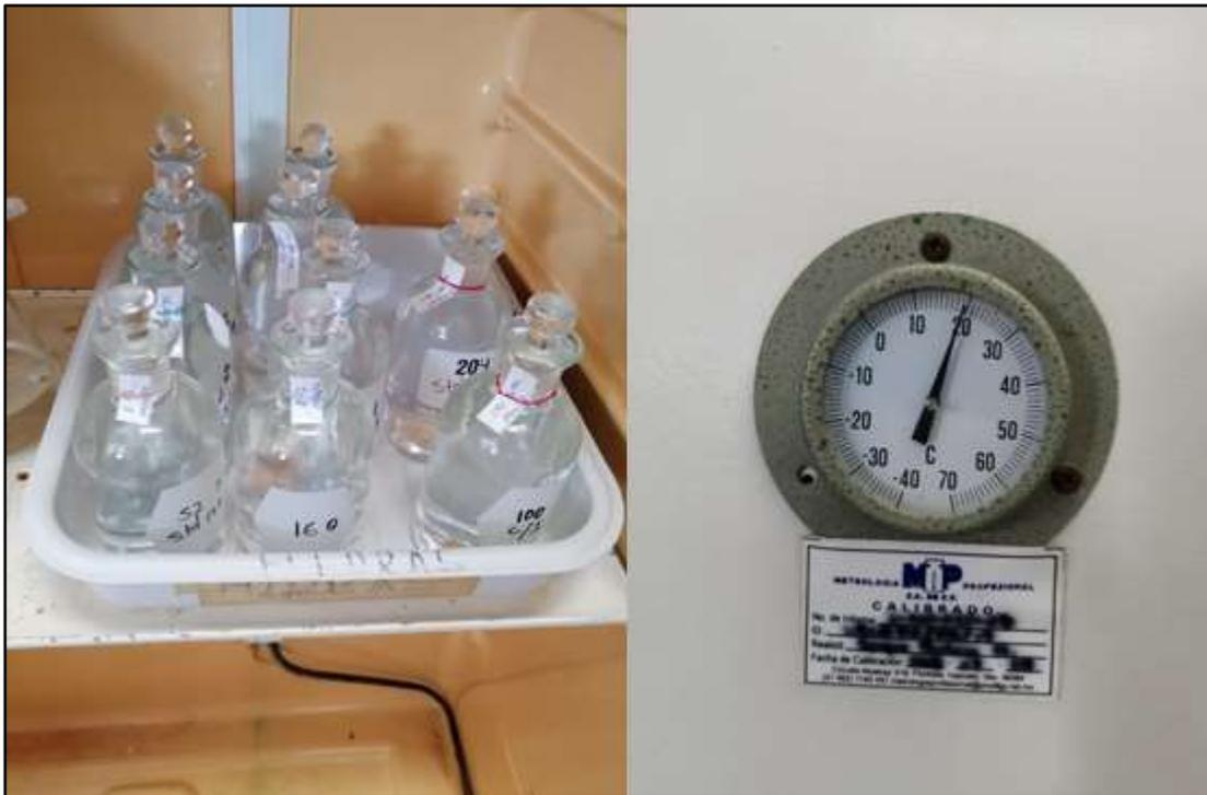
Se prepara las muestras del día cero con Sulfato Manganeso, Alcalina de Yoduro y Ácido Sulfúrico, de acuerdo al procedimiento que se muestra en el anexo 8, para poder titularlo con Tiosulfato de Sodio y la indicadora de almidón, de manera que se tenga registrado en la bitácora y eso sea de utilidad para los cálculos del quinto día.
