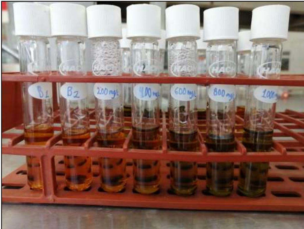
Al tener etiquetado y acomodado cada tubito de digestión en la gradilla, se comienza a agregar con una pipeta volumétrica, 2 ml de agua destilada a los blancos y 2 luego ml de cada concentración a su tubo correspondiente. Es necesario mencionar que es muy importante el lavado y secado correcto de las pipetas graduadas, así como
