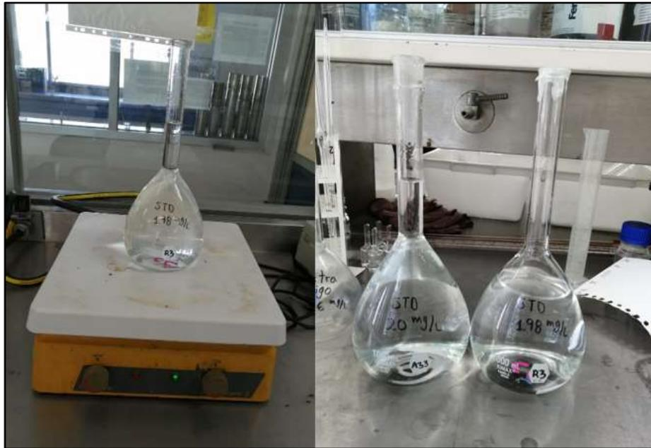
Se realiza la valoración del Tiosulfato de Sodio y para ello se prepara la disolución de yoduro de potasio, con dicromato de potasio, ácido sulfúrico y agua destilada. Esto se realiza en 3 matraces Erlenmeyer, para que, al titularlo con el Tiosulfato de sodio y el indicador de almidón, se obtenga 3 resultados obtenidos de los cálculos de la fórmula de la molaridad, se saque la media y se obtenga la molaridad del Tiosulfato de Sodio a utilizar en las pruebas de desempeño.
