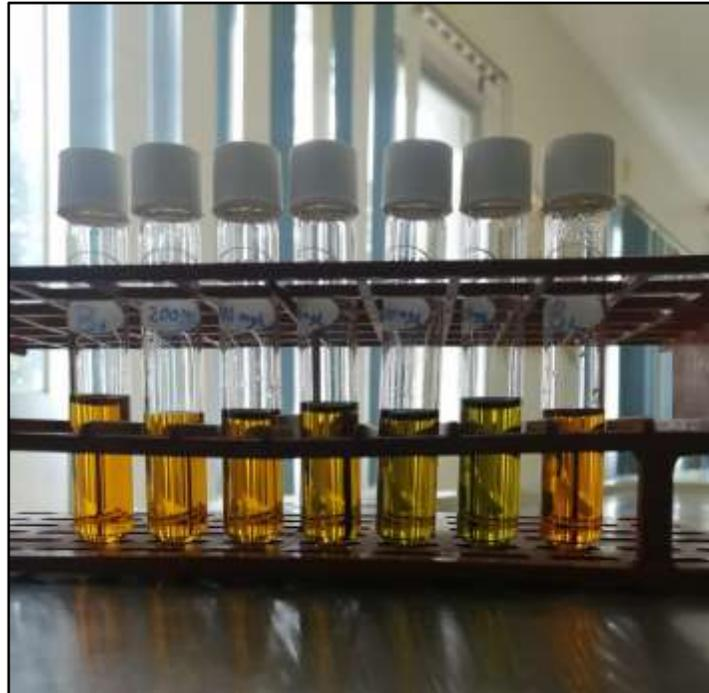
Como se puede observar en la ilustración 30, esos son tubos sellados de digestión de **altas concentraciones** y después de la digestión cada tubo cambia notoriamente su color debido a la diferente concentración de la solución madre de referencia que contiene.
