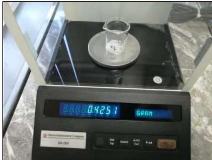
Después de pesar el ftalato de potasio, se procede a disolverlo en un matraz volumétrico de 500 mL con agua destilada hasta aforarlo, para después agitarlo hasta diluirse por completo.
