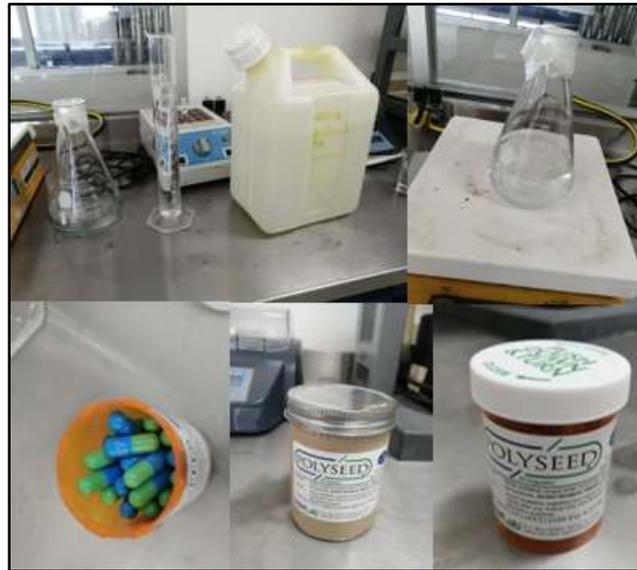
Al pasar la hora de agitación del inóculo comercial POLYSEED, se procede a dejar reposar durante 30 minutos, para que se realice el proceso de filtrado con ayuda de la bomba de vacío.
