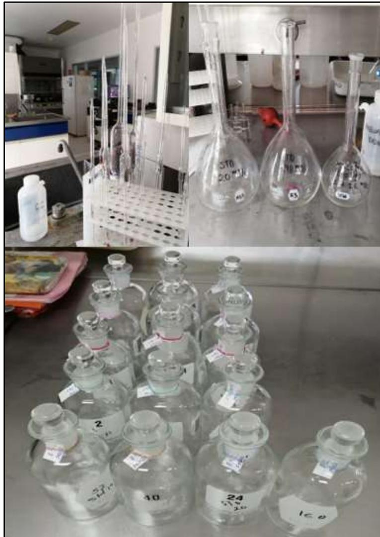
Al tener el agua de dilución preparado, es importante checar el pH, debido a que debe estar en el rango de 6.5 a 7.5 de pH, porque es una de las condiciones que se toma en cuenta para que sobrevivan los microorganismos, la otra condición es que este a una temperatura de 20°C. En esta prueba de desempeño se obtiene un pH de 7.3 en el agua de dilución preparada.
