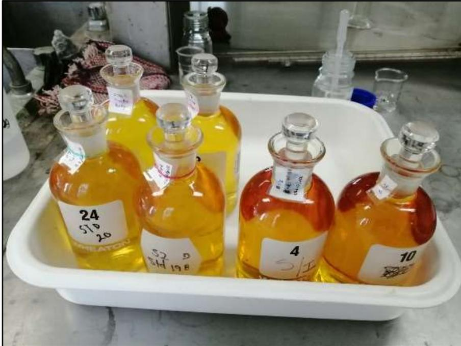
Al tener las muestras preparadas, se toma una alícuota de 100 ml con una bureta y se vacía en un matraz Erlenmeyer de 250 ml, para poder titularlo. Al momento de la titulación con el tiosulfato de sodio, se le agrega 3 gotas de solución indicadora de almidón al momento que la muestra tomará un color amarillo pálido e inmediatamente se torna de un color azul. Por último, se sigue titulando tiosulfato de sodio hasta la desaparición de color, como se muestra en la ilustración
