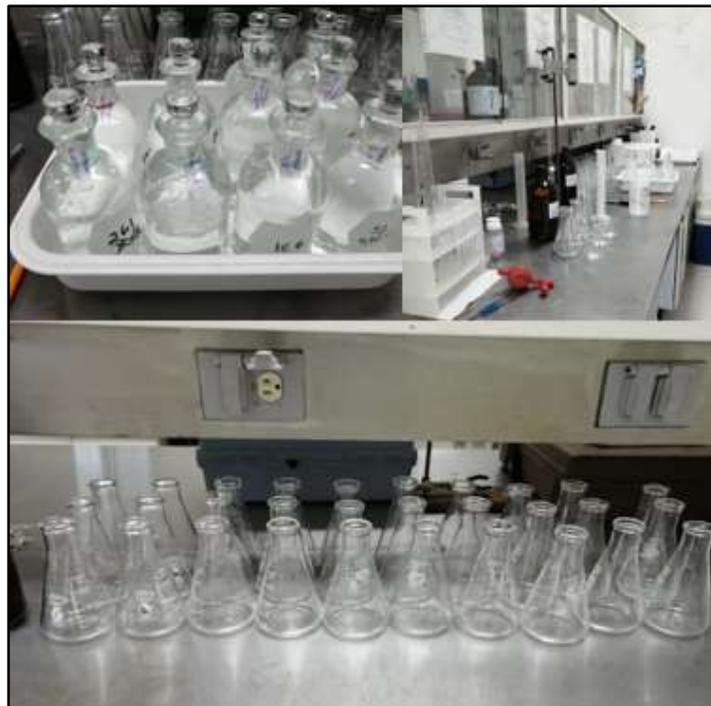
Se preparan las muestras del quinto día con Sulfato Manganeso, Alcalina de Yoduro y Ácido Sulfúrico, de acuerdo al procedimiento que se muestra en el anexo 8, para poder titularlo con Tiosulfato de Sodio y la indicadora de almidón, de manera que se tenga registrado en la bitácora y eso sea de utilidad para los cálculos.
