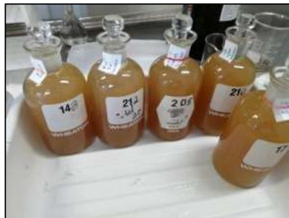
*Ilustración 12. Muestras después de añadirles ácido sulfúrico*
