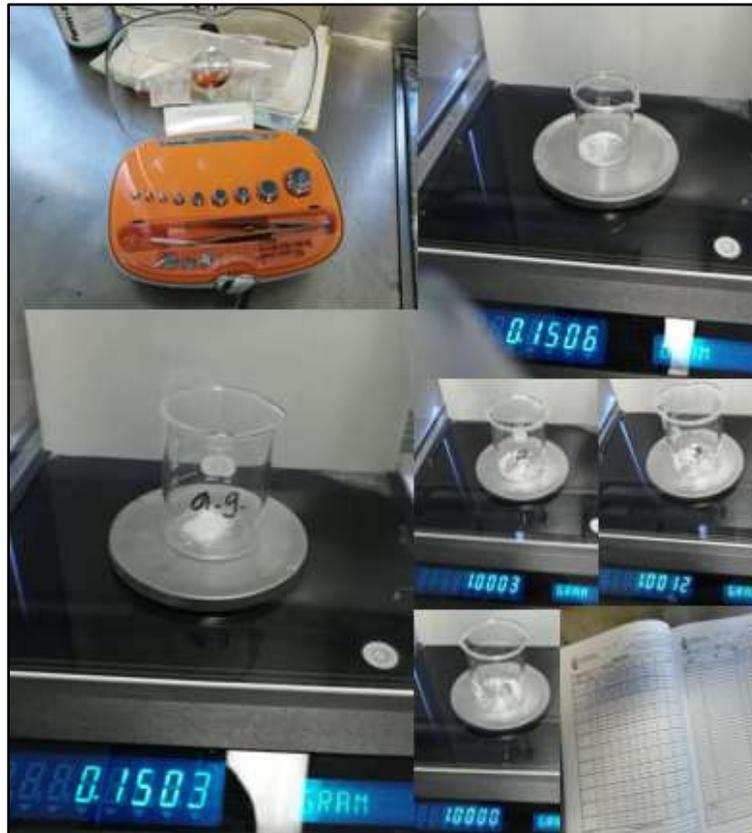
Se procede a realizar la preparación del estándar de 198 mg/L en un matraz volumétrico de 1000 mL y con una agitación de 30 minutos de manera que se diluya completamente, para que después se preparé el estándar de 20 mg/L en un matraz
