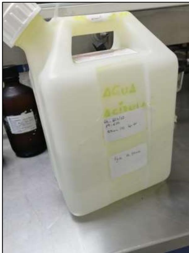
Después de llenar la garrafa con el volumen deseado de agua desionizada, se añade 1 ml de cada nutriente que son las disoluciones siguientes: disolución de sulfato manganoso, disolución amortiguadora de fosfatos, disolución de cloruro calcio y disolución de cloruro férrico, por cada litro de agua desionizada, como se puede observar en la ilustración 14.
