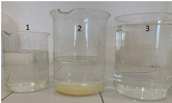
Figura 44.- 1) Apariencia del agua cruda que es suministrada a la PTAP "San Antonio"; 2) apariencia del agua que recibió un tratamiento con hipoclorito de sodio, hidróxido de calcio y polímero; 3) apariencia del agua a la salida del filtro prototipo con arena sílica y zeolita como material filtrante. Elaboración propia.
