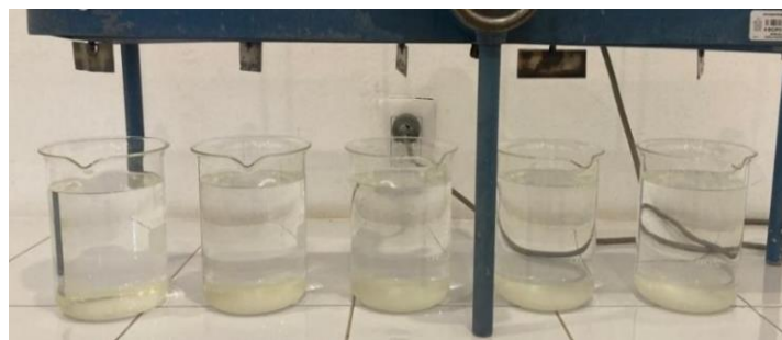
Figura 38.- Apariencia de las jarras con hidróxido de calcio y polímero después de 2 horas. Elaboración propia.
