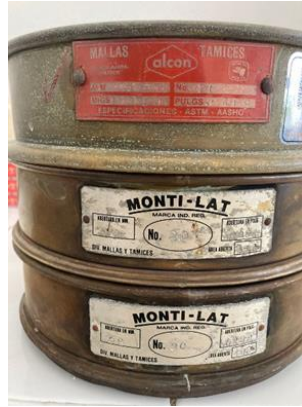
Figura 30.- Tamices utilizados para cribar los lechos filtrantes (arena sílica y zeolita). Elaboración propia
