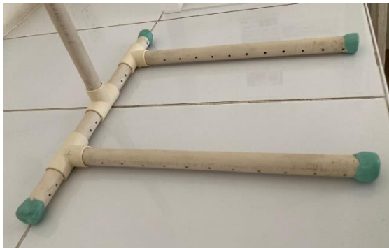
Figura 28.- Tuberías de CPVC para distribución del agua. Elaboración propia.
