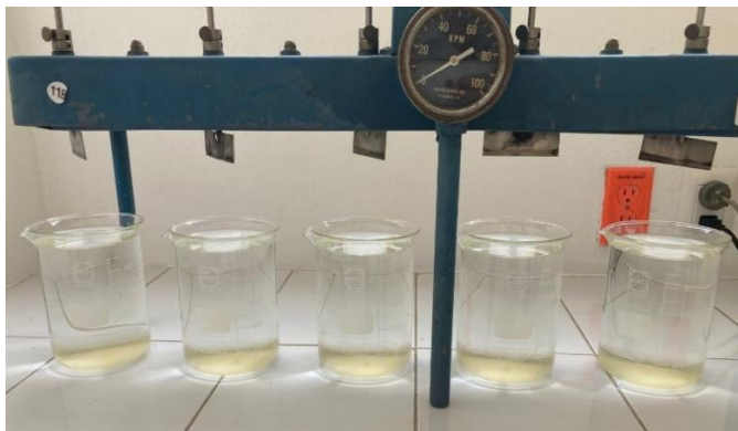
Figura 42.- Apariencia del agua tratada con hipoclorito de sodio, hidróxido de calcio y polímero. Después de una hora se aprecia el sedimento formado en el fondo de los vasos de precipitado. Elaboración propia.
