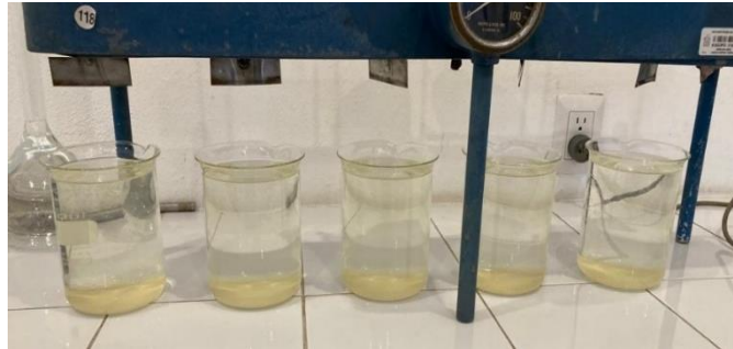
Figura 37.- Apariencia de las jarras con sulfato de aluminio y polímero después de 2 horas. Elaboración propia.
