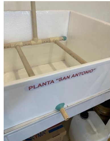
Figura 28.- Tuberías de CPVC para distribución del agua. Elaboración propia.
