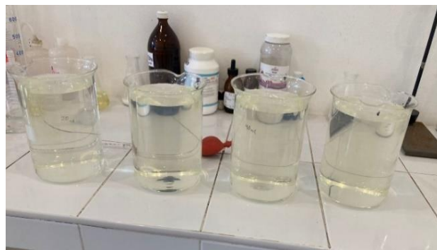
Figura 41.- Apariencia del agua cruda que se suministra a la PTAP "San Antonio". Elaboración propia.
