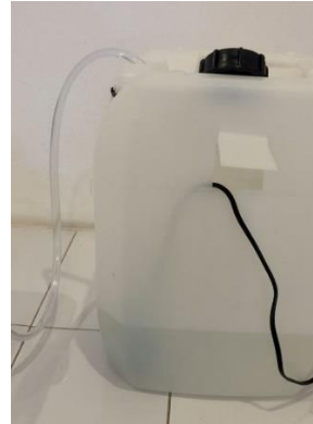
Figura 43.- Después de que los sólidos disueltos sedimentaran, se decantó el agua en el garrafón de 20 L. para luego ser bombeada al filtro prototipo. Elaboración propia.
