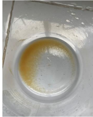
Figura 43.- Después de que los sólidos disueltos sedimentaran, se decantó el agua en el garrafón de 20 L. para luego ser bombeada al filtro prototipo. Elaboración propia.
