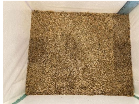
Figura 31.- Lecho soporte de grava y lecho de arena sílica. Elaboración propia.
