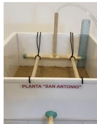
Figura 32.- Lecho de zeolita y vista frontal del filtro prototipo. Elaboración propia.
