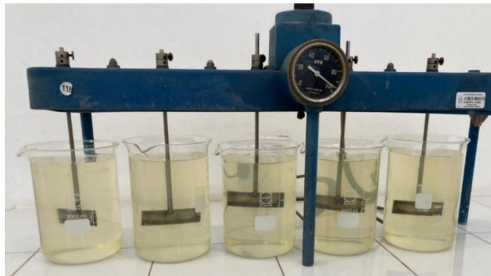
Figura 36.- Apariencia de las jarras antes de suministrar floculante y coagulante. Elaboración propia.
