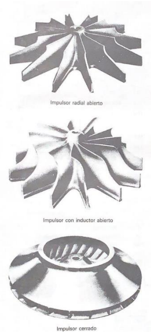
Ilustración 19. Impulsores de una etapa para compresores.
