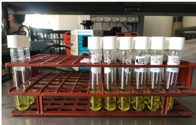
*Ilustración 10. Tubos DQO de bajo intervalo (hasta 150 mg/L) elaborados de acuerdo a la Norma NMX-AA-030/2-SCFI-2011*
