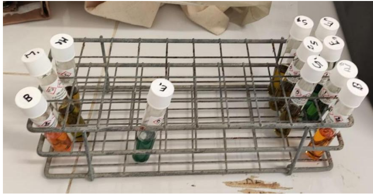
Figura 10. Viales de digestión utilizado para el análisis de la QDO.
