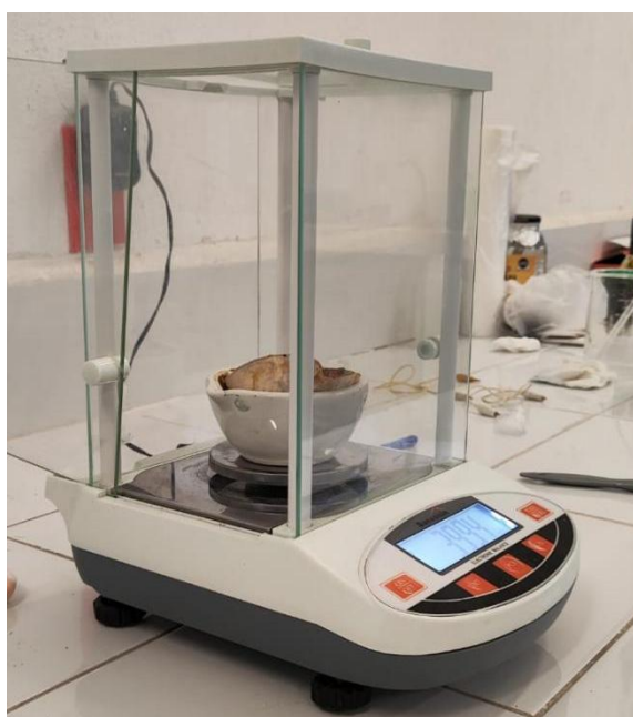
Figura 8. Balanza analítica utilizada para el pesos seco de todos los tratamientos.
