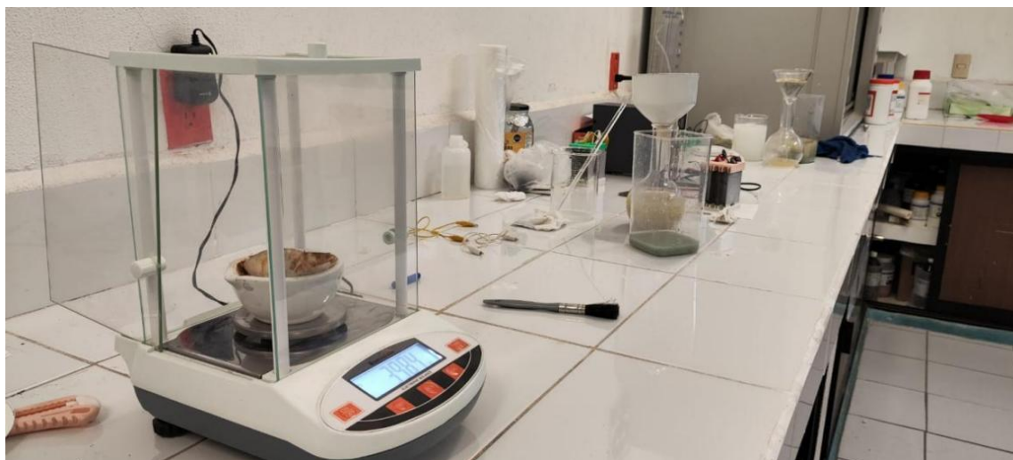
Figura 7. Balanza analítica utilizada para el pesos seco.
