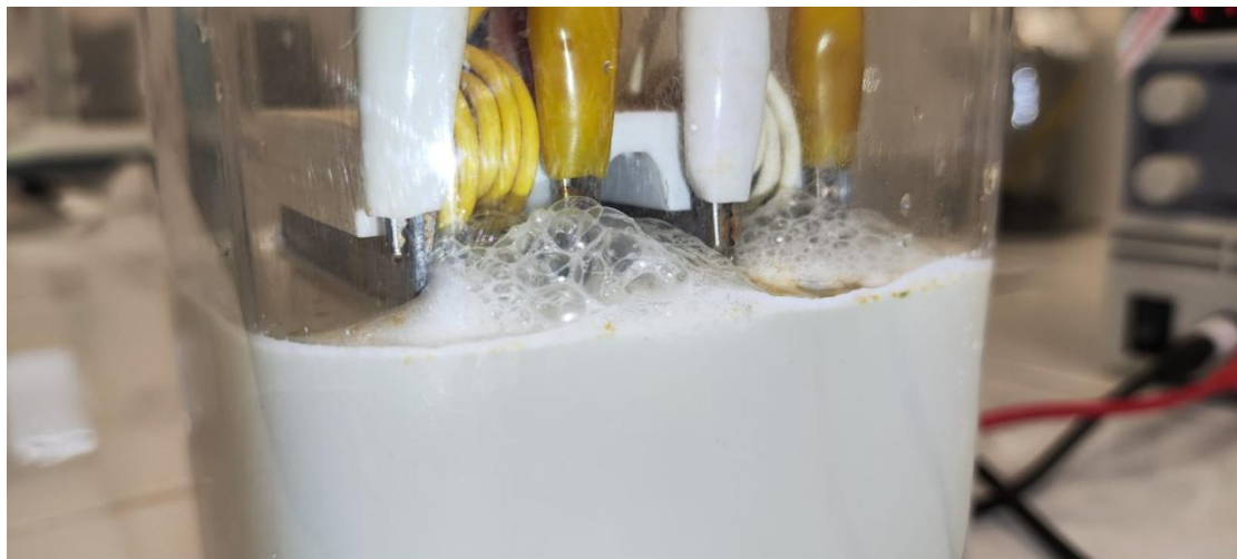
Figura 11. Material biológico electrocoagulación dentro del reactor.
