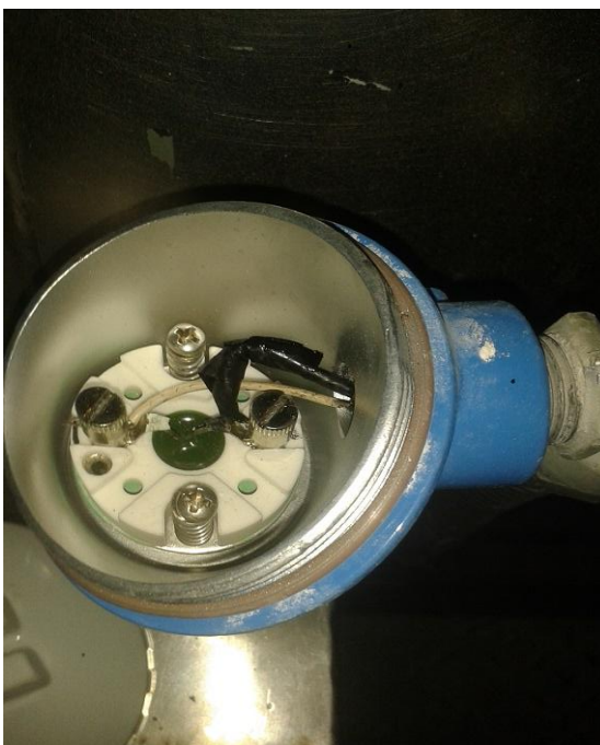
Figura 2.5b cableado de termopar
