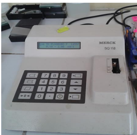
Ilustración 7. Espectrofotómetro SQ118 marca Merck.
