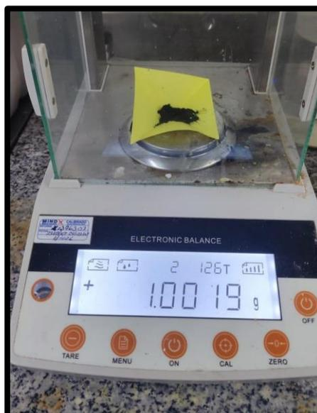
*Figura 9. Pesando muestra de carbón*
