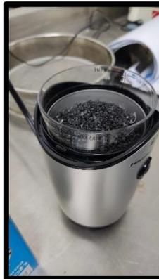
*Figura 5. Muestra en el triturador.*
