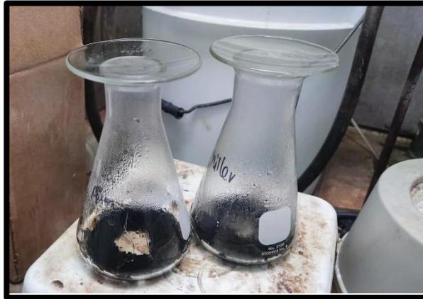
*Figura 10. Muestras de carbón con HCL.*
