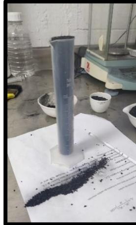
*Figura 25. Probeta llena de la muestra.*
