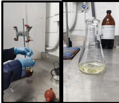
*Figura 14. Titulando con tiosulfato de sodio.*
