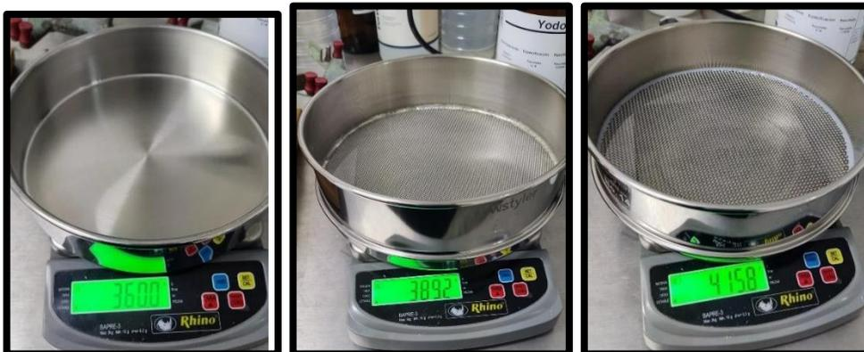
*Figura 19. Pesando tamices a utilizar.*
