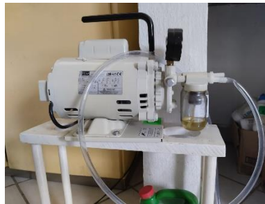
Figura 19. Bomba de vacío como equipo de filtración para determinar SST. (Elaboración propia).
