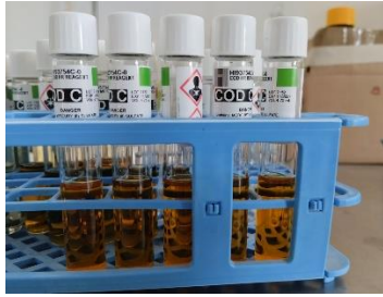
Figura 21. Viales con reactivo para determinar DQO. (Elaboración propia).
