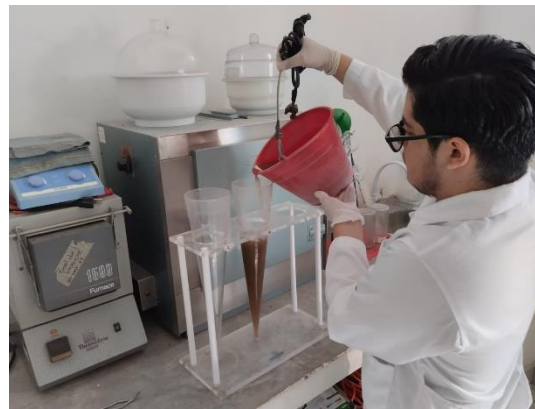
Figura 17. Puesta de lodos residuales en los conos Imhoff. (Elaboración propia).
