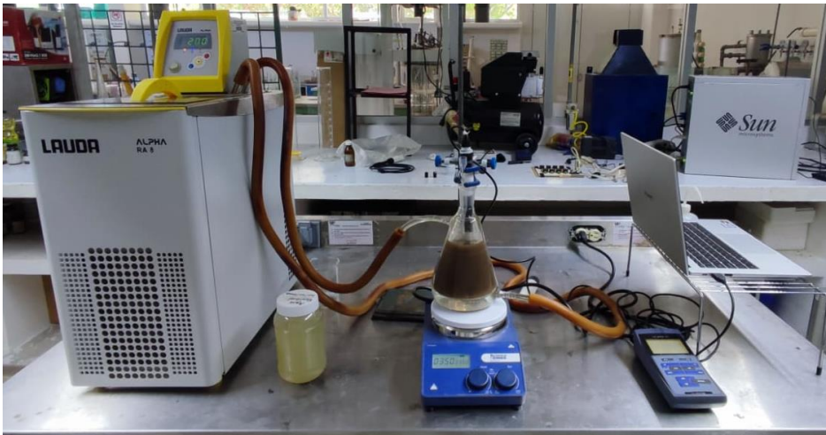
Ilustración 4. Montaje de reactor para la determinación de K_s .
