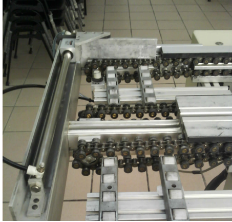
Fig. 3.6 Pistón de cambio de banda principal a secundaria
