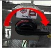
Desconectar todas las fuentes de energía peligrosa: energía electrica se coloca el hand switch en posición de off.
