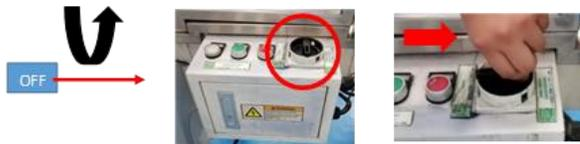
Desconectar todas las fuentes de energia peligrosas, para la energia eléctrica se coloca el hand switch en la posición de off.
