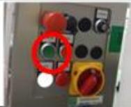
Se libera energía almacenada apretando boton verde de arranque de la máquina
