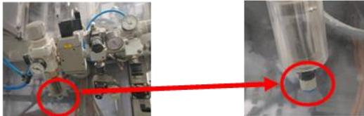
Se libera energía neumática en la purga de los filtros festos, como se muestra en la imagen.
