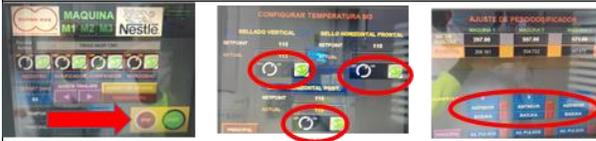
Parar el equipo con el boton STOP, apagar mordazas horizontales y verticales (off), apagar agitador y bazuca desde el panel de control view de la llenadora a intervenir.
