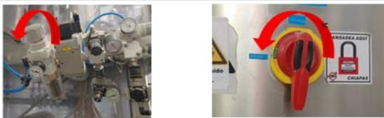
Desconectar todas las fuentes de energía peligrosas, desconecta la tapadora de la fuente de energia (conector) y cerrar la valvula de aire, como se muestra en la imagen.
