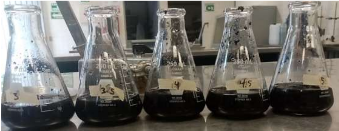
Figura 20: Preparación de las muestras para los isotermas de adsorción C.A.
