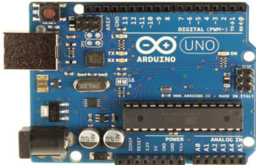
Fig. 9.- Muestra las terminales del arduino uno
