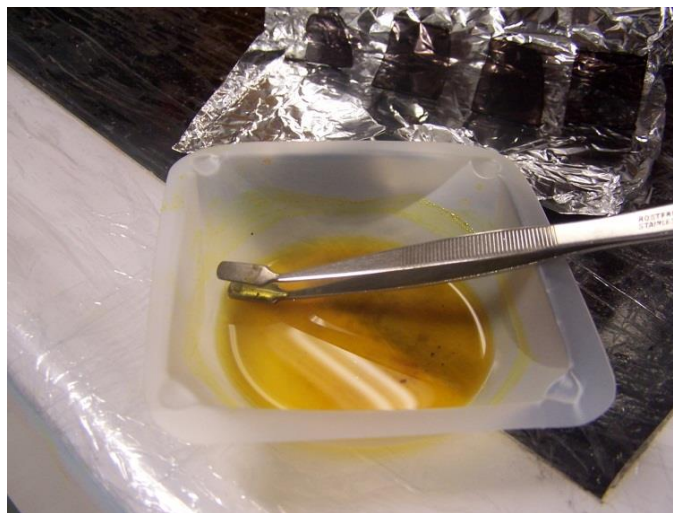
Figura C.10. Muestra la solución de cloruro férrico con nitrometano
