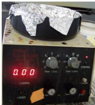
Imagen 1.2. Spin coating utilizado en el laboratorio de materiales (se puede ajustar revoluciones a las cual puede hacer girar el sustrato con solución)
