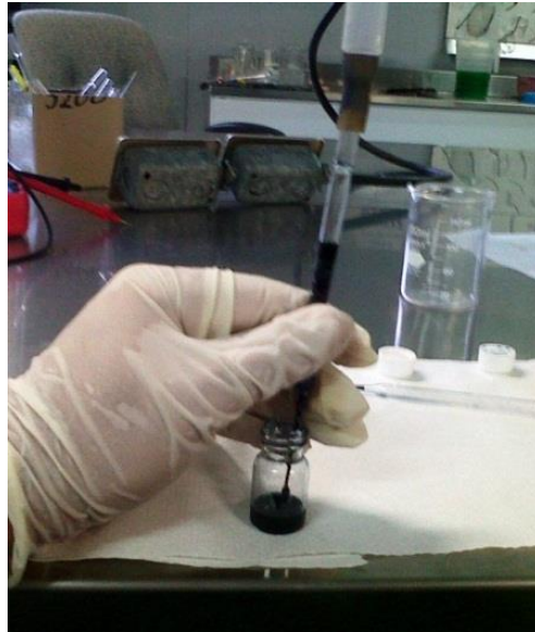
Figura B.5. Muestra cómo se filtra el PEDOT:PSS
