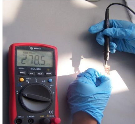
Figura C.4. Caracterización de una celda OPV bajo luz solar.
