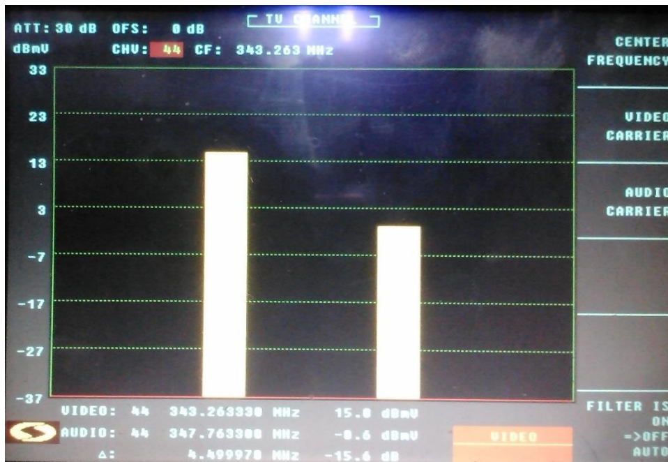
Fig. 3.8 - En la imagen se muestran las gráficas del canal análogo 44, audio y video, son dos cosas distintas.
