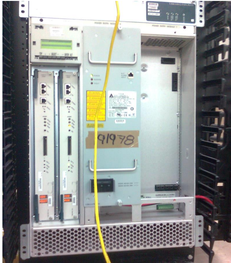
Fig. 3.17 - UBR aún no configurado completamente y con una sola fuente de alimentación, esta es la parte frontal.
