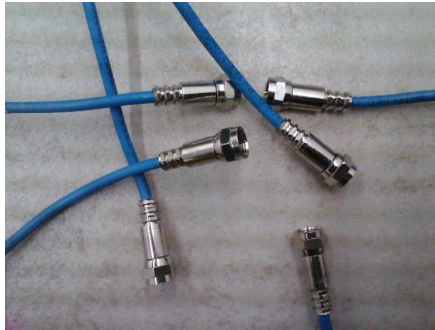
Fig. 3.22 - Cables mini coaxiales ponchados con su respectivo conector, estos conectores se usan para el cableado de down stream y up stream (servicios de internet y telefonía).
