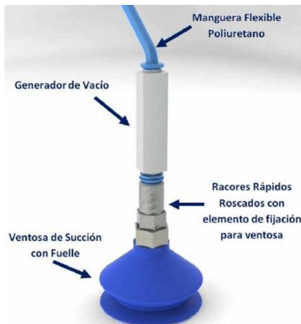
Figura 3.12. Sistema de succión para una extremidad.
