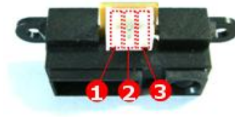
Figura F.2 Conexiones eléctricas DMS. [3]
