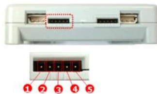
Figura 4.2. Conexiones eléctricas CM-510. [3]
