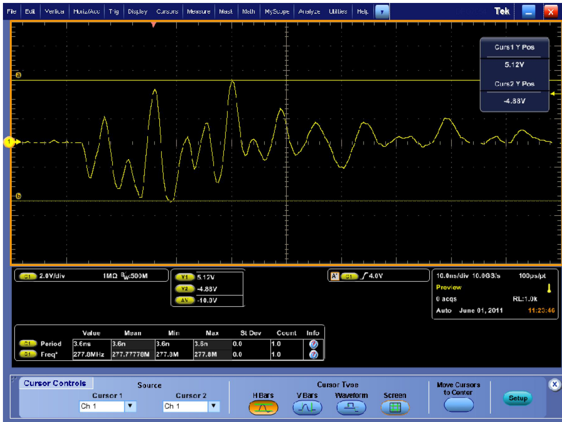
Fig. 5.2 Voltaje pico a pico provocado al encendido de la fuente de corriente.
