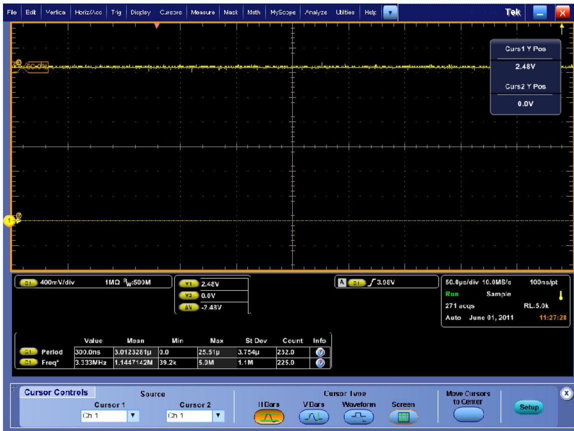
Fig. 5.6 Medición del voltaje de operación del LPS-636-FC.
