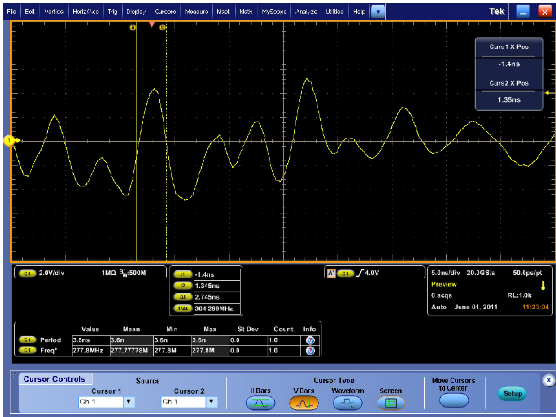
Fig. 5.3 Amplitud del voltaje pico a pico provocado al encendido de la fuente de corriente.
