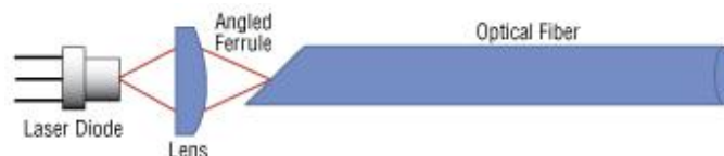
Fig. 2.9 Estructura interna de un láser Pigtail
