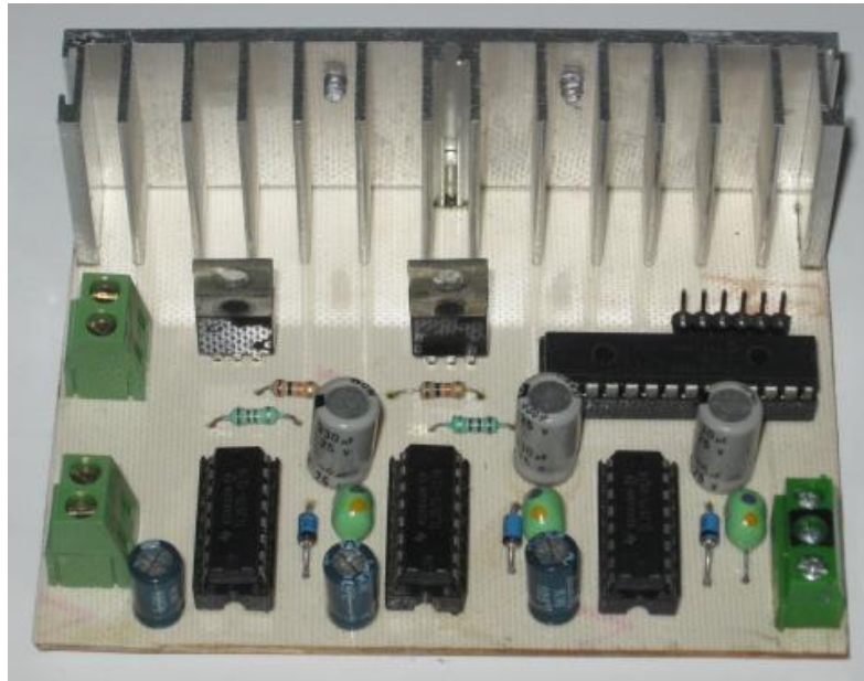
Control PID para la temperatura interna.
