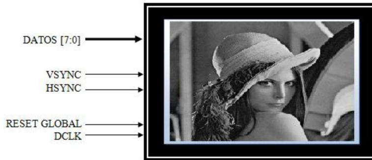
**Figura 2424** Señales de entrada de la pantalla TRDB\_LCM.
