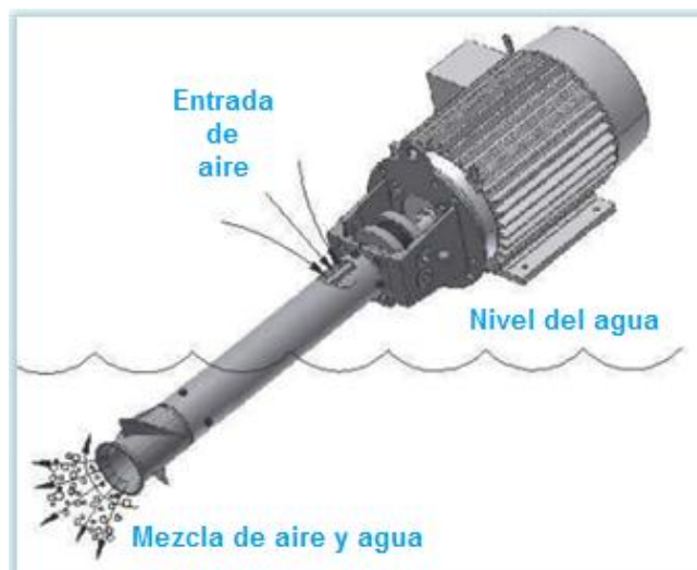
Figura 3.5 operación del aireador
