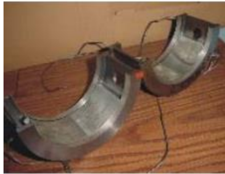
FIGURA 2.9 ENSAMBLES INFERIORES DE CHUMACERAS.
