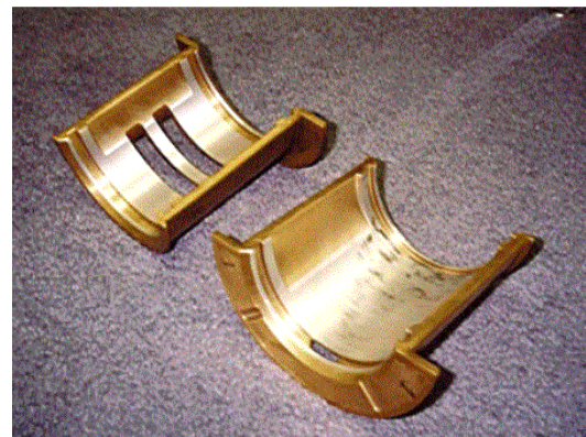
FIGURA 2.6 CHUMACERA PLANA CON DOS RANURAS PARA ENTRADA DE ACEITE
