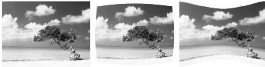
FIGURA 0.6 FACTORES DE DISTORSIÓN EN UNA IMAGEN: IMAGEN ORIGINAL, DISTORSIÓN TIPO BARRIL Y DISTORSIÓN TIPO COJÍN, RESPECTIVAMENTE.
