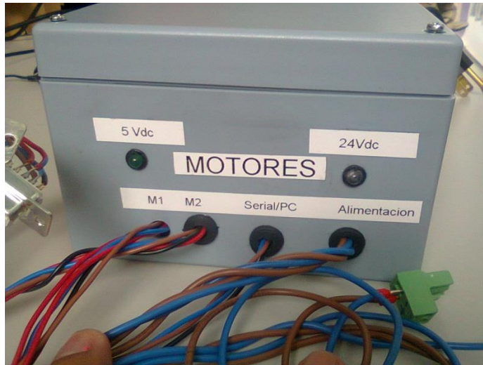
FIGURA 0.21 GABINETE PARA FUENTE Y CONTROLADOR DE MOTORES A PASOS
