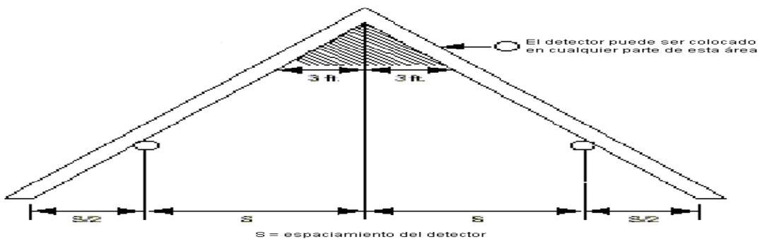
Figura 4.14.2 Espaciamiento del detector en techo inclinado
