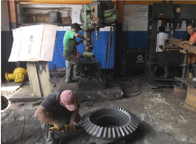
A-A5 Trabajadores sin uniforme y equipo de protección
