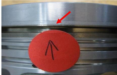
Fig. 4.11 Posición incorrecta del alfin
