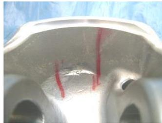
Fig. 4.14 Defecto de pintura en la falda interior
