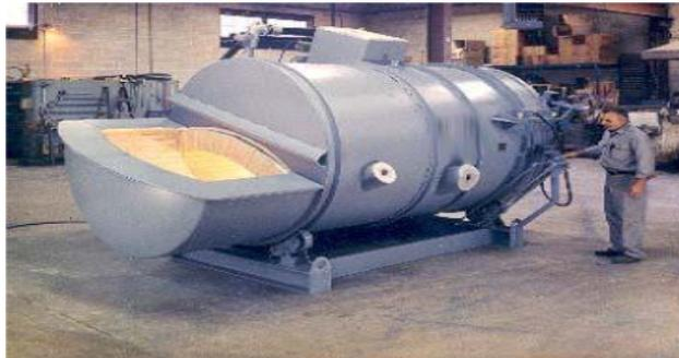
**Fig. 2.8 Horno de reverbero o tambor basculante**
