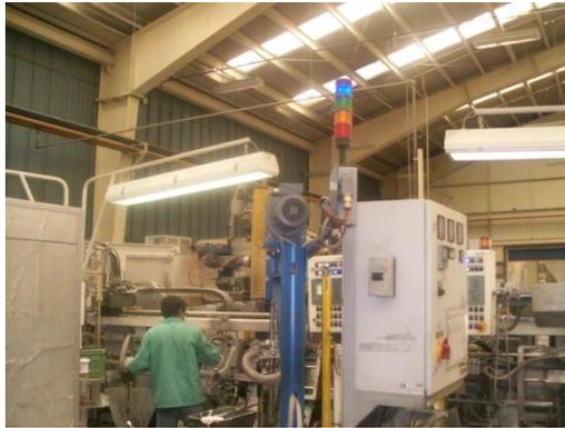
**Fig. 2.13** Máquina productora de pistones
