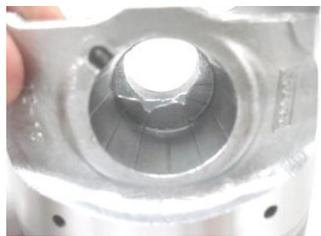
Fig. 4.7 Rebaba en el barreno de perno
