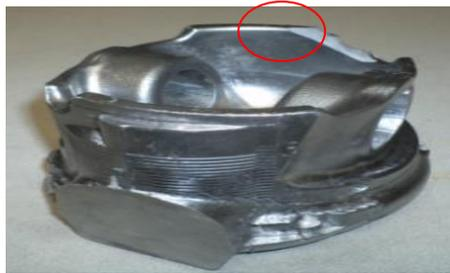
Fig. 4.13 Pistón fracturado en el spigot
