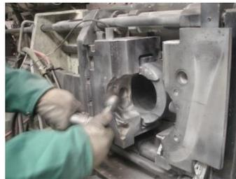
En la siguiente foto se muestra el proceso de aplicación de pintura, es en éste proceso donde se quedan partículas de pintura adheridas al molde pudiendo dejar una marca en la pieza.
