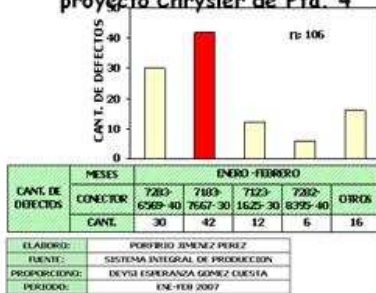
Grafica por numero de conectores rotos del diseño 56055-715 de la línea 5 de la familia INP del proyecto Chrysler de Pta. 4
