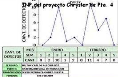
Grafica mensual de pestañas dañadas del conector 7183-7667-30 del diseño 56055-715 de la línea 5 de la familia
