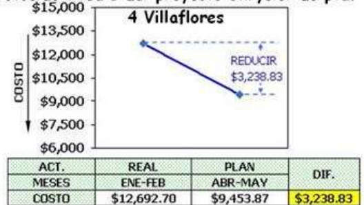
Grafica de costo de retrabajo de conectores rotos de línea 5 del proyecto Chrysler de pta. 4 Villaflores
