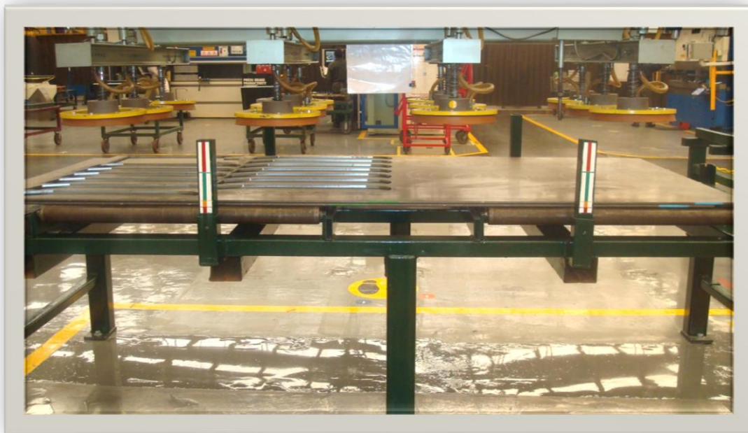
Figura 5.9 Ejemplo de la cuarta T, mesa de placas con bases plegables para identificar rangos.
