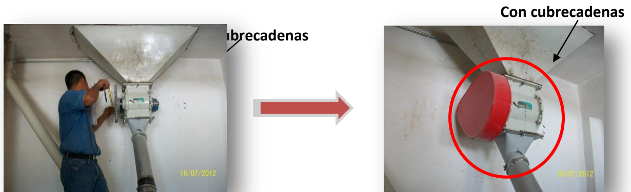
Figura 5.5 Fabricación y montaje de un cubrecadena para evitar accidentes (Fuente: Elaboración Propia).
