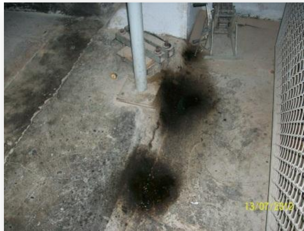
Figura 5.12 Fugas de aceite en el área de transmisión. (Fuente: Elaboración Propia).
