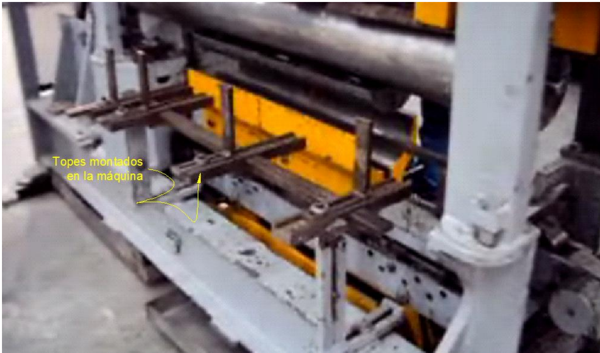
Figura 5.17. Topes Actuales (Instalados en la Selladora) (Fuente: imagen tomada de la empresa)
