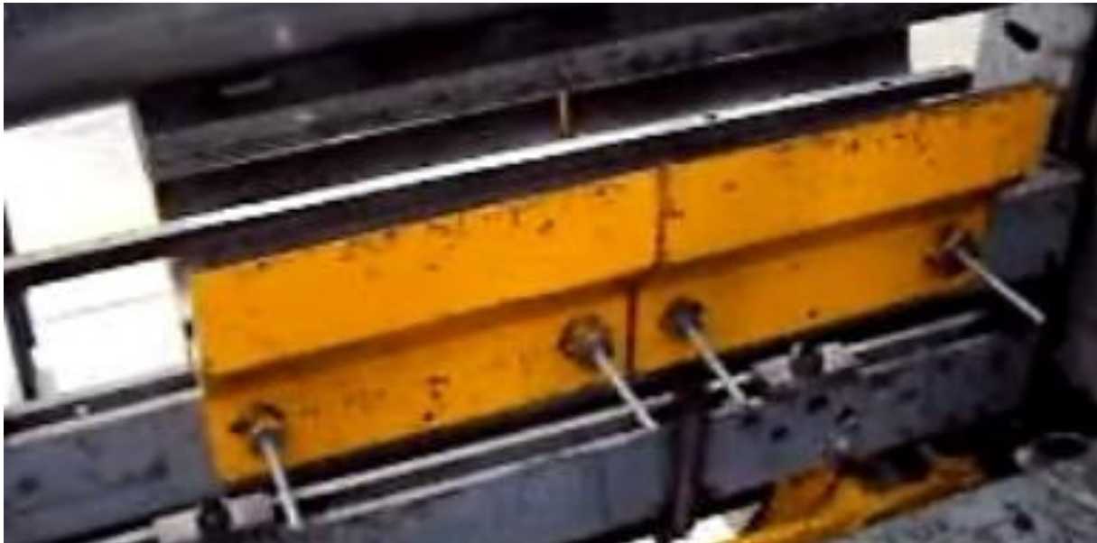
Figura 5.12. Diseño Actual de Mordazas (Instaladas en la Máquina) (Fuente: imagen tomada de la empresa)
