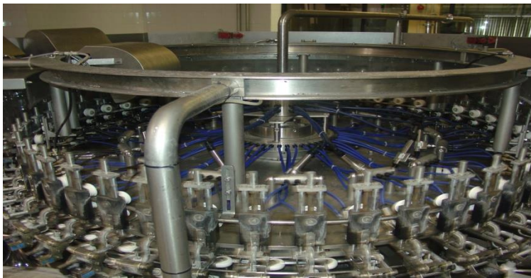
Imagen 5.3 Boquillas de inyección
